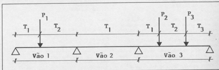
Figura 1 - Trechos de uma viga contínua
